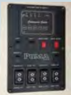
Panneau moniteur mural pour rallonges, lumières, lumières d'entrée, pompe à eau/chauffage; charge de la batterie et détails sur la capacité des réservoirs
