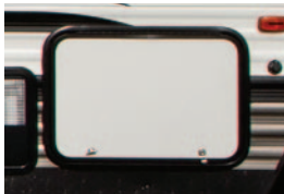
Portes de coffre arrondies et scellées à la silicone pour protéger des éléments
