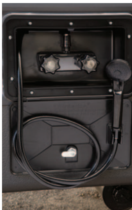
Douche extérieure avec eau chaude et froide
