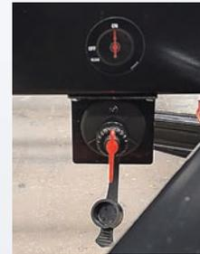
Le sectionneur de batterie Seaflo contrôle la consommation d'énergie. Fonctionne par clé amovible
